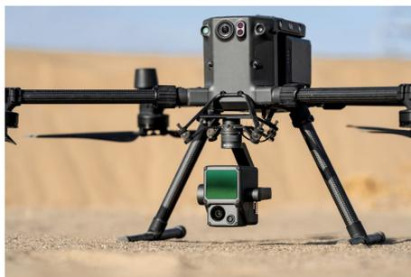
Matrice 300 RTK avec LIDAR (source DJI)
